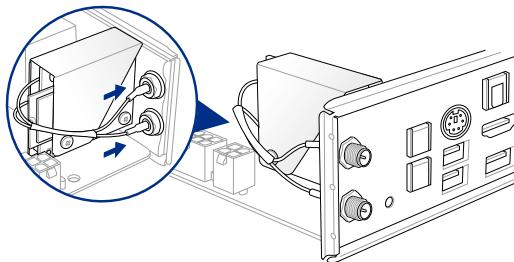
3. 然后再将螺栓装回天线连接口上，并且将 I/O 挡板固定在定位。
