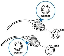
2. 将天线连接口装入后侧 I/O 挡板的 Wi-Fi 接口安装孔，如下图所示。
