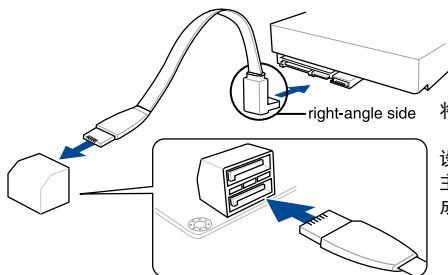
将 SATA 信号在线的直角接口端 (right angle side) 连接在 SATA 设备上，或是将直角接口端安装至主板内置的 SATA 接口，以避免造成与较大大显卡的冲突。
