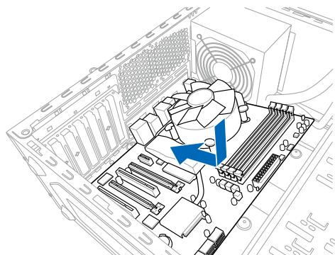
3. 将四个螺丝放入主板上的螺丝孔并旋转锁紧，以确保将主板锁至机箱。
