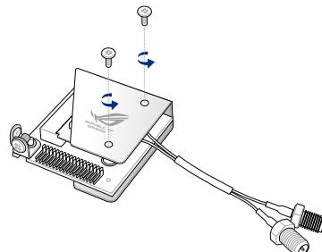
2. 移除背面的 1 颗长螺丝，然后将金属铁壳取出并放置于一旁。
