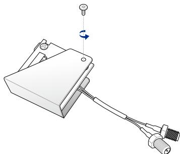
5. 翻转至金属铁壳的正面，并锁上步骤 1 所移除的 2 颗短螺丝。
